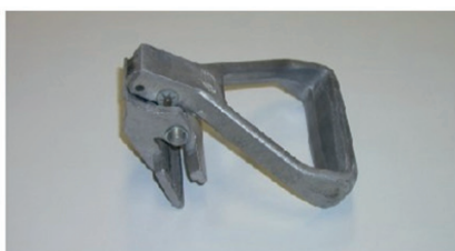
приспособление для зачистки (обдирки) напольных покрытий
