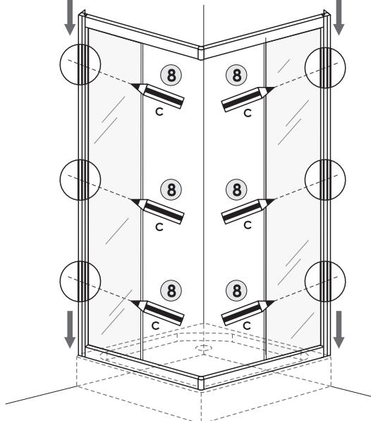
9. Просверлите стены и установочный профиль (рис. 9).
