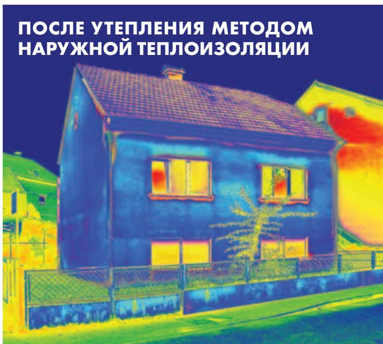
ПОСЛЕ УТЕПЛЕНИЯ МЕТОДОМ НАРУЖНОЙ ТЕПЛОИЗОЛЯЦИИ
