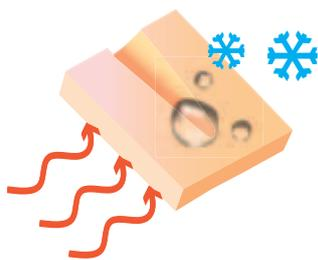
**Увлажнение стен** происходит в течение всего отопительного периода из-за разницы температур внутри и снаружи. Когда теплый воздух охлаждается при диффузии через промерзшую стену дома, то неизбежно возникает конденсат.
